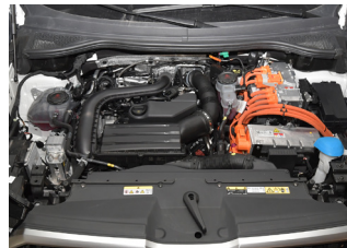
Оранжеви кабели в двигателния отсек
