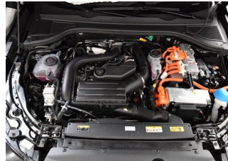
Narančasti kablovi u motornom prostoru
