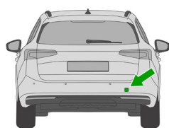
Argola de reboque traseira, no lado direito do veículo
