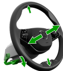
Mechanické nastavenie stĺpika riadenia
