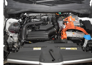
Cables de color naranja en el compartimento del motor
