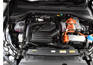
Orangefarbige Kabel im Motorraum
