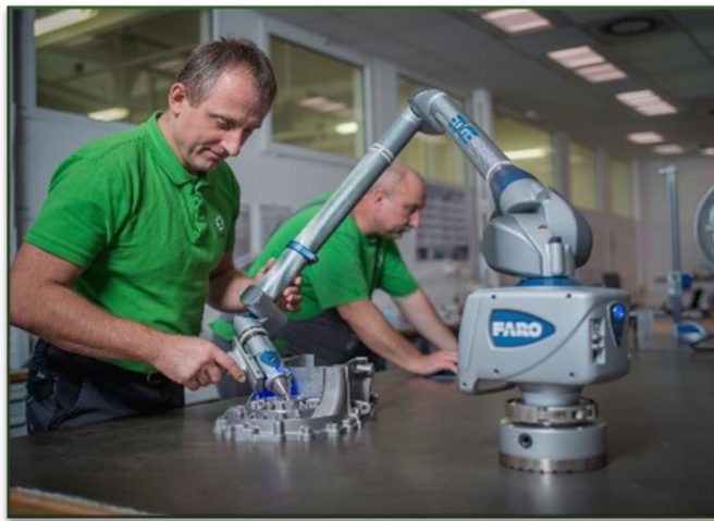
Měření 7osým ramenem Faro
