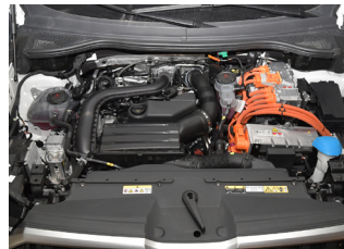
Πορτοκαλί καλώδιο στον χώρο του κινητήρα
