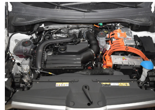
Oranžinės spalvos kabelis variklio skyriuje
