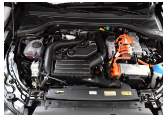
Pomarańczowe kable w przedziale silnikowym
