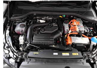
Oranžový kabel v motorovém prostoru
