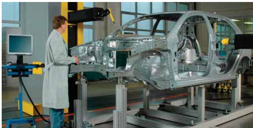
Kontrola rozměrů karosářských dílů na souřadnicovém měřicím zařízení
