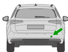
Anneau de remorquage côté arrière droit du véhicule
