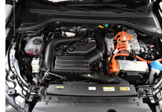
Πορτοκαλί καλώδιο στον χώρο του κινητήρα
