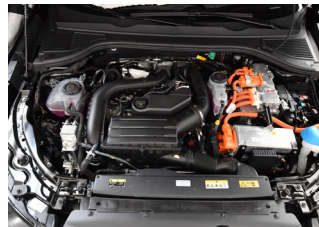
Narančasti kablovi u motornom prostoru
