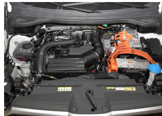
Oranžový kábel v motorovom priestore
