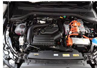
Cablu portocaliu din compartimentul motorului
