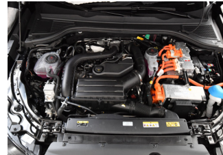
Oranje kabel in de motorruimte
