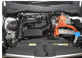
Pomarańczowe kable w przedziale silnikowym
