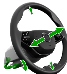
mechanické nastavení sloupku řízení
