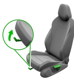
Réglage mécanique du siège
