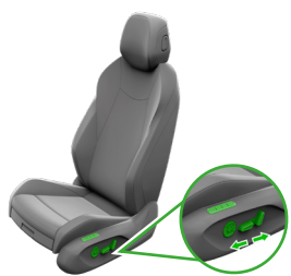
Réglage électrique du siège
