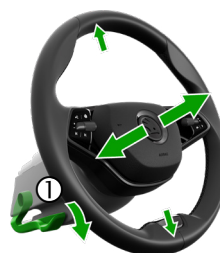
Réglage mécanique de la colonne de direction
