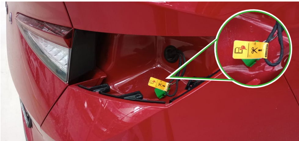
Místo pro nouzové odpojení pod zadním světlem, viz také Nové označení pro modely vyrobené po roce 2023.
