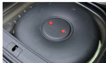
Nádrž na LPG na dně zavazadlového prostoru
