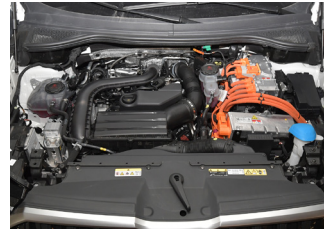
Oranje kabel in de motorruimte
