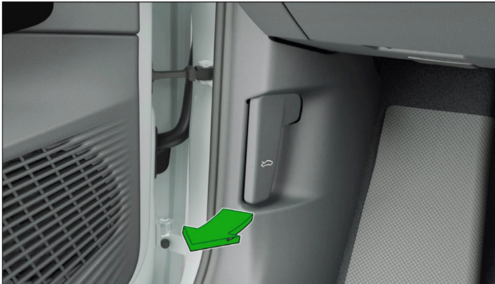
Im Fußraum auf der Fahrerseite: Entriegelungshebel für die Frontklappe
