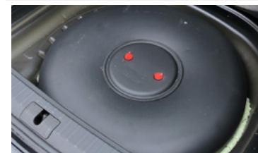
Autogas- bzw. Flüssiggastank im Gepäckraumboden
