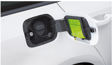
Erdgasanschluss am Tankeinfüllstutzen
