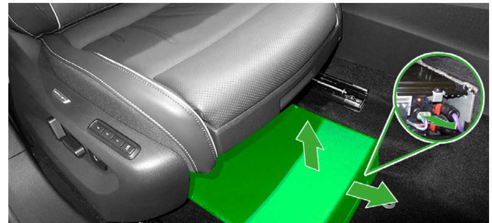
Abklemmen des 48-Volt-Bordnetzes bei Superb Modell ab 2023
