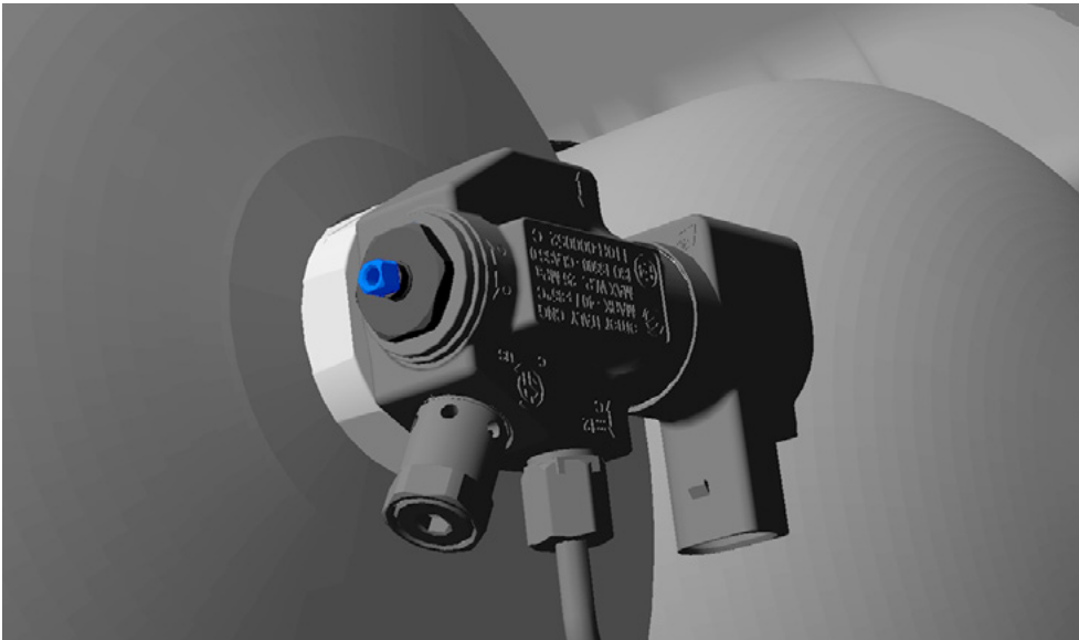
Absperrventil mit 5-er Maulschlüssel bzw. Zange oder Spezialwerkzeug im Uhrzeigersinn bis zum Anschlag drehen
