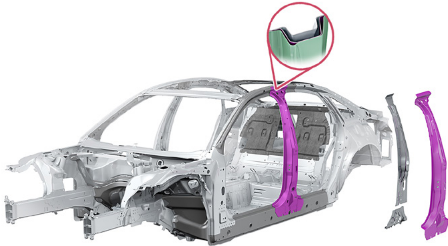
B-Säule mit mehrschaligem Aufbau
