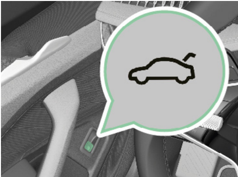
Taster in der Türverkleidung Fahrerseite
