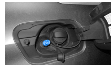
Flüssiggasanschluss am Tankeinfüllstutzen
