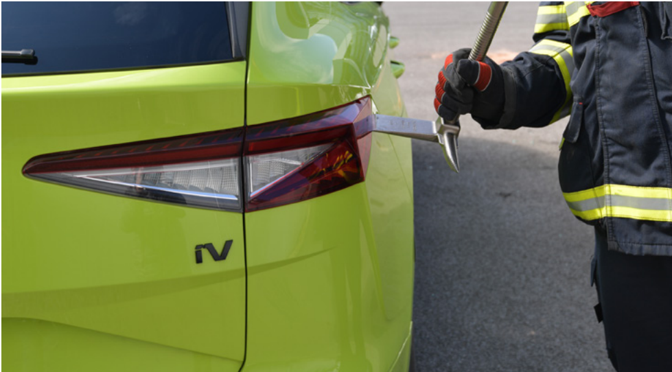
En los vehículos fabricados a partir de 2023, el punto de corte del alto voltaje también se encuentra detrás del grupo óptico trasero derecho
