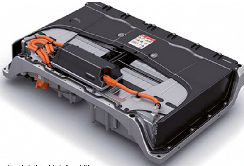
La batería de alto voltaje del vehículo Superb iV
