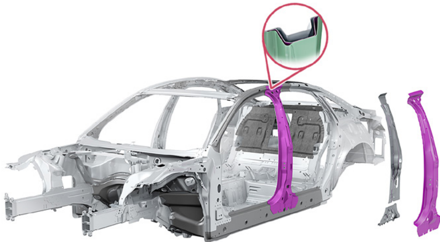
Pilar B con estructura multicapa
