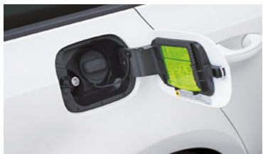
Toma de gas natural junto a la boca de llenado
