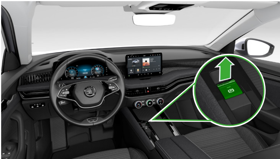
Vehículo con motor convencional y transmisión automática: Utilizar el freno de estacionamiento electrónico o tire de la palanca del freno de mano
