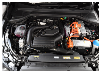
Orangefarvet kabel i motorrummet
